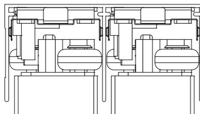
1 Закрепите доводчик саморезами, с одной стороны подложив шайбу. Установите доводчик упор к ребру верхнего горизонтального профиля.
