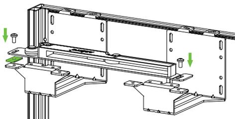
3 Установите ответную планку доводчика до упора вверх в верхнюю направляющую с необходимой стороны. Отрегулируйте дверь и зафиксируйте ответную планку саморезами.
