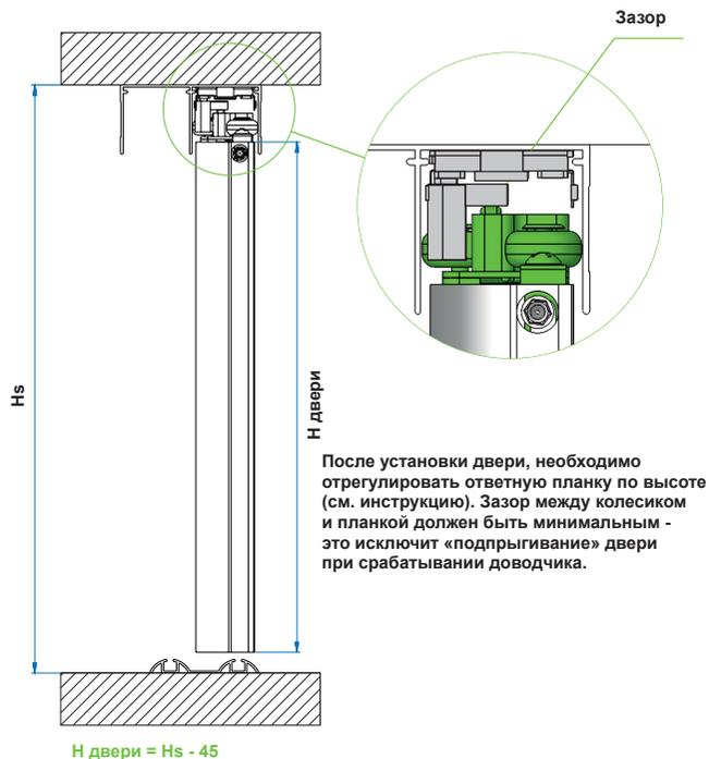
После установки двери, необходимо отрегулировать ответную планку по высоте (см. инструкцию). Зазор между колесиком и планкой должен быть минимальным - это исключит «подпрыгивание» двери при срабатывании доводчика.
